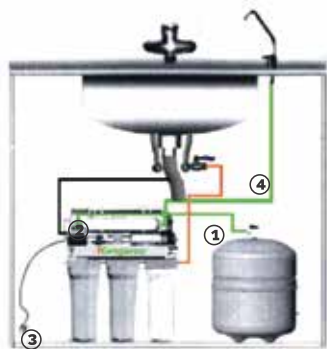
Hình 1: Sơ đồ lắp dưới tủ bếp
