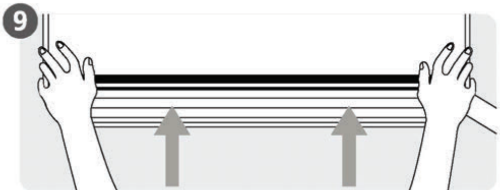
9 Lắp dàn lạnh (Trang 26)
