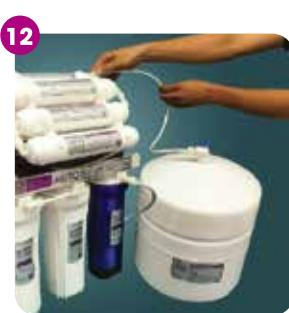
Kết nối đầu chở trên cút chữ T của lõi T33 với bình áp bằng đoạn dây RO nhỏ, sau đó để van bình áp ở trạng thái khóa.
