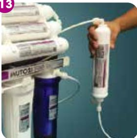
Nối một đoạn dây RO nhỏ từ đầu côn lại T33 và dòng ra vị trí xả nước quy định. Dụng lõi T33 theo chiều thẳng đứng trước khi tiến hành sục rửa chất bảo quản của lõi T33.
