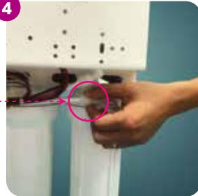
Tại cút đầu ra của cốc lọc số 3, tháo dây RO nối từ vị trí này với đầu vào của màng RO. Sau đó lấy đoạn dây RO nhỏ (rồi bên ngoài) nối trực tiếp từ cút đầu ra của cốc số 3 đến vị trí xả nước để chuẩn bị quá trình sục rửa các lõi 1,2,3.
