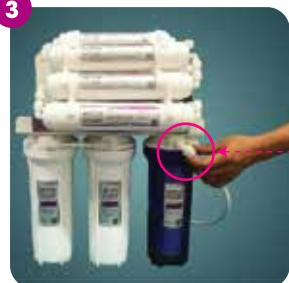
Nối dây RO với cút đầu vào của cốc lọc số 1. Khi lắp đặt cần đảm bảo cút ốc phải được quấn băng tan và xiết hết ren nhằm tối ưu lực liên kết giữa dây RO và cút ốc.
