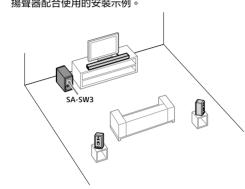
1 隨處安裝重低音揚聲器。 您可以將重低音揚聲器安裝在您想要放置的地方,因 為它的聲音輸出沒有指向性。 上圖即為重低音揚聲器的安裝示例。
