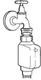
ống cấp nước an toàn
