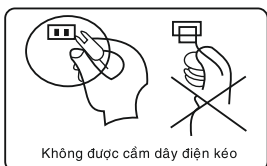
Không được cắm dây điện kéo
