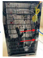
9. Gắn chốt khóa vào van cấp nước đến ngò vào khe hở để khóa chặt vòng khóa.
